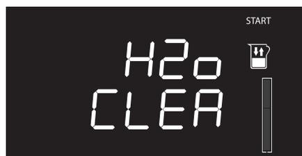
2. Enfoncez la manette des fonctions pour confirmer la sélection de la fonction. L'afficheur indique la demande de remplissage du réservoir.
