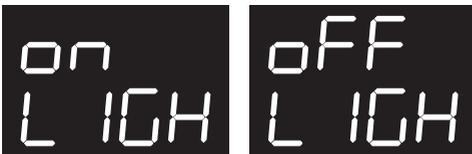
Pour empêcher l'appareil d'éteindre la lampe automatiquement au bout d'une minute, réglez ce mode sur OFF.
